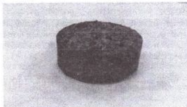
Рис. 1. Брикет из лузги подсолнуха при p=250 кг·с/см 2
